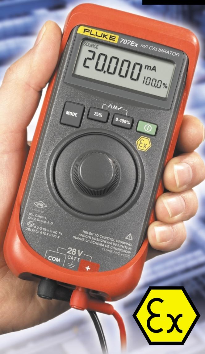
707Ex ist ein eigensicherer Stromschleifenkalibrator für den Einsatz in explosionsgefährdeten Bereichen. Darüber hinaus erfüllt dieser Kalibrator die Forderungen der ATEX-Direktive (Ex II 2 G Eex ia IIC T4) in den Zonen 1 und 2. Für die Funktion entsprechend Factory Mutual N.I. Klasse 1, Division 2 Bereiche Gruppe A-D ist er ebenfalls zertifiziert.
