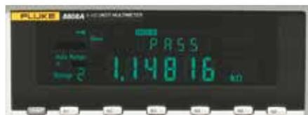
Über die Setup-Tasten (S1 - S6) ist die schnelle Durchführung wiederholter Messungen möglich. Diese gespeicherten Einstellungen können auch den Grenzwertvergleichsmodus mit Gut/Schlecht-Indikatoren enthalten.
