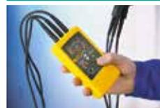
Ermittlung der Drehfeldrichtung in mehrphasigen Stromnetzen
